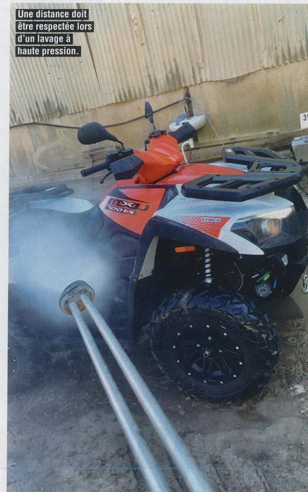
Appliquer un produit dégraissant permet de décoller les saletés du quad ou du SSV.
