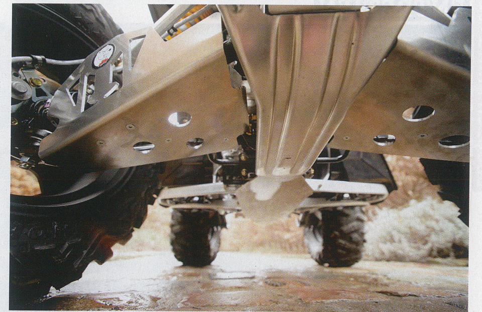
Jeter un œil sous le quad permet de déceler la présence de caillou ou de branches coincés.
